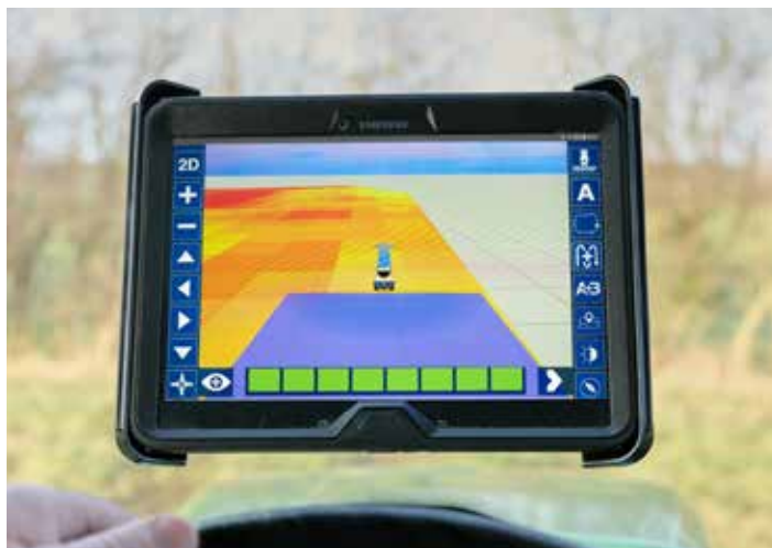
NAVI-app for GPS-assistert spredning via Android-nettbrett (krever CALIBRATOR TOTZ).
