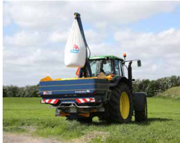
BXL 1300 kan løfte opp til 1300 Kg og kan monteres på spredere opp til 3300 liter.
