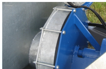
Spredde pumpe med rustfri aksel og lejebox adskilt fra gyllen. Kraftig stål skærm om cardan.
