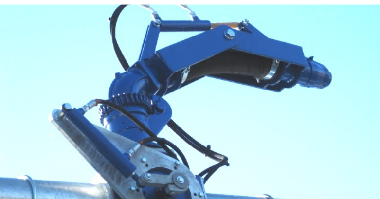
Hydraulisk drejebær højtryks kanon Højdeindstilling som fast, eller hydraulisk regulerbar.
