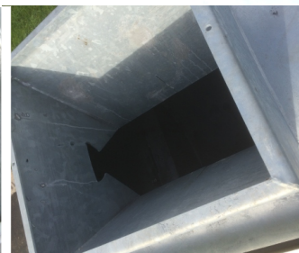
Standard fyldetrakt, forberedt for Automatisk lukke trakt.
